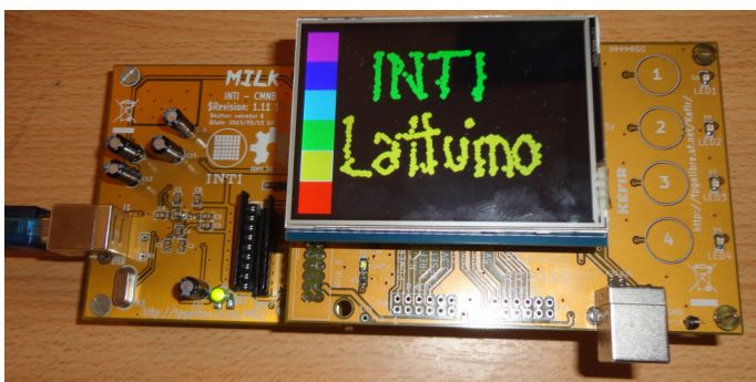
Figura 3. Utilización de un shield de Arduino.
