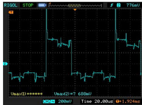
Figura 6. Tensión a la entrada del comparador (caso 1)
